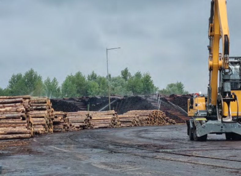
Část mokrého skladu na Pile Paskov.
